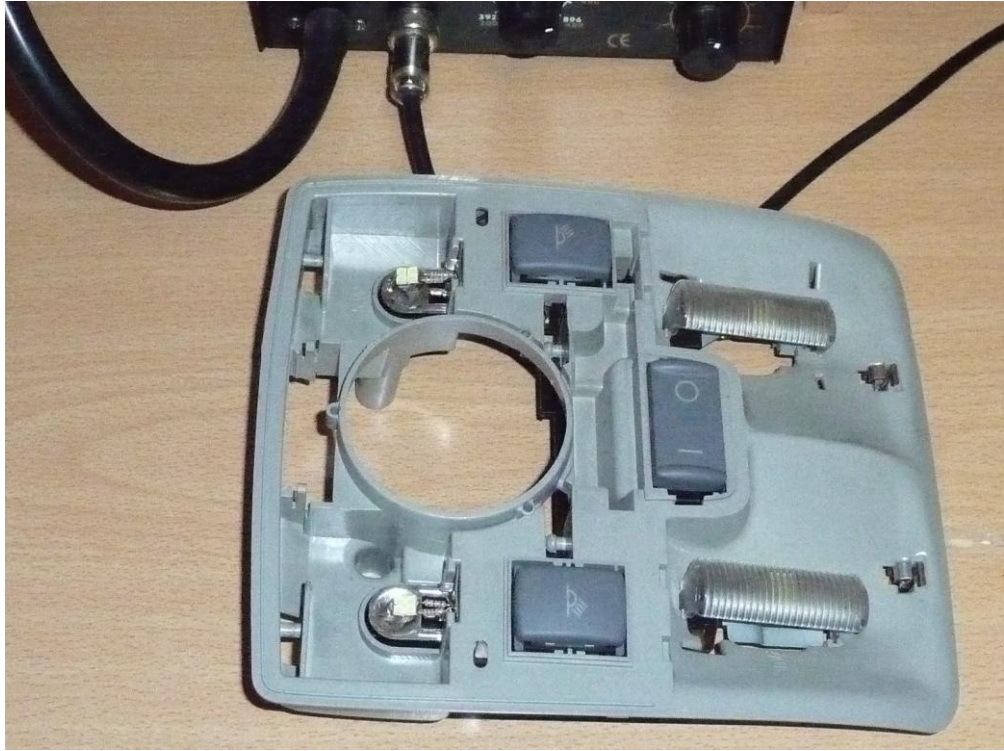
Une fois démonté, le plafonnier se declipse facilement, on enlève la fiche électrique
