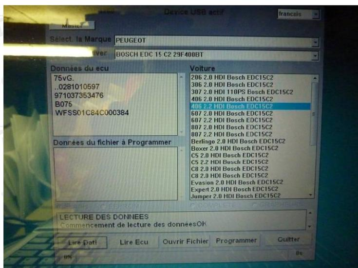
Cliquer sur "lire Dati" permet de voir les refs de la carto et du calculo. Cela confirme aussi que le contact avec le calculateur est Ok !
