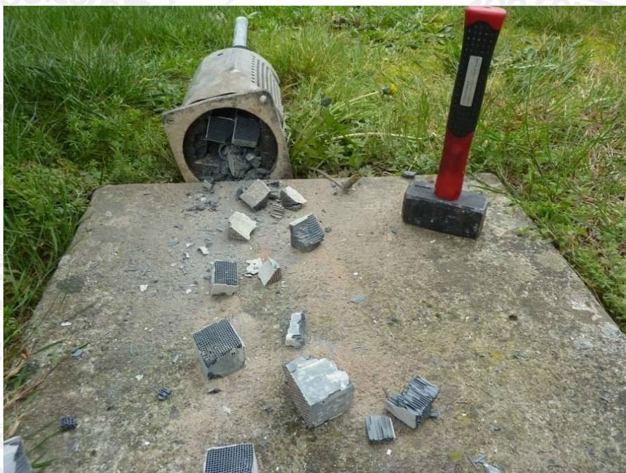
Encore quelques coups par la sortie pour agrandir, puis le reste vient facilement par l'entrée. Gaffe à la poussière ! Dans la céramique subsiste une poussière fine, jaunâtre. J'ai fait ça dans un endroit en courant d'air donc je n'en ai pas respiré, sans quoi, j'aurais pris un masque. La cérine est un produit irritant, donc mieux vaut pas en respirer !
