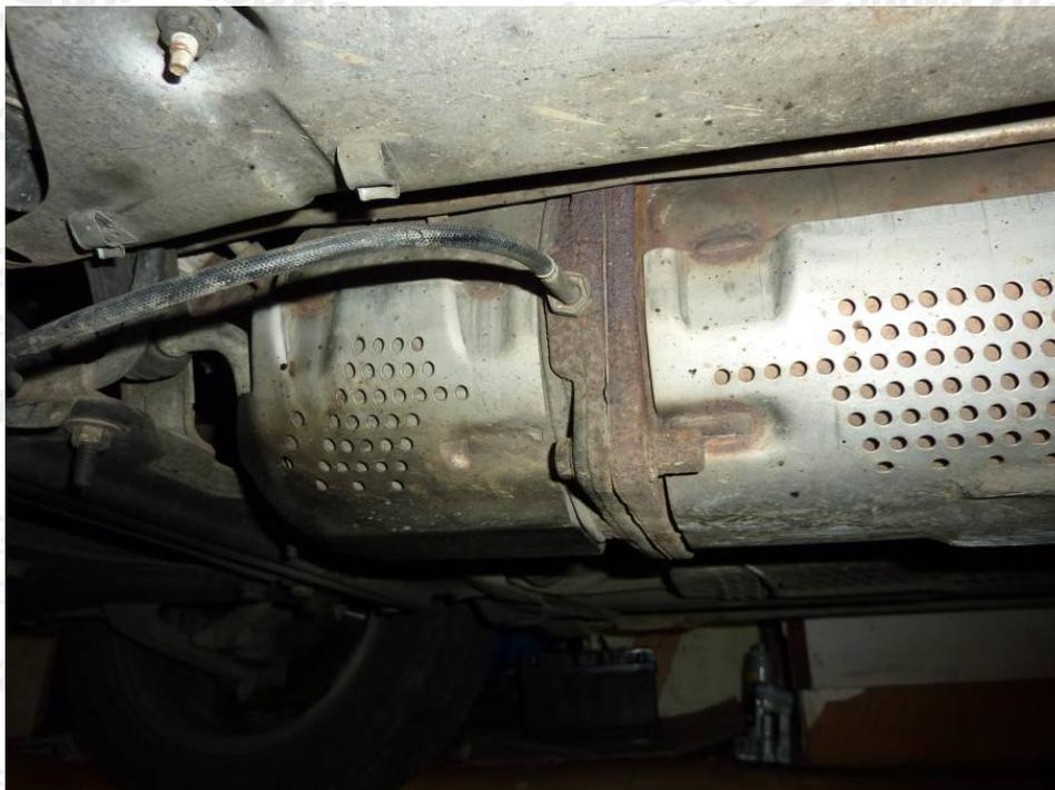
Pas de mystère, faut déposer le tuyau fap/silencieux, car ce tuyau rentre dans le fap, 5 ou 7 cm. Un coup de wd40 et les colliers se desserrent facilement. On commence par ôter le collier sur la sortie du fap, puis sur le silencieux. Ensuite, le tuyau vient facilement. Il n'est pas nécessaire de tomber le silencieux.
