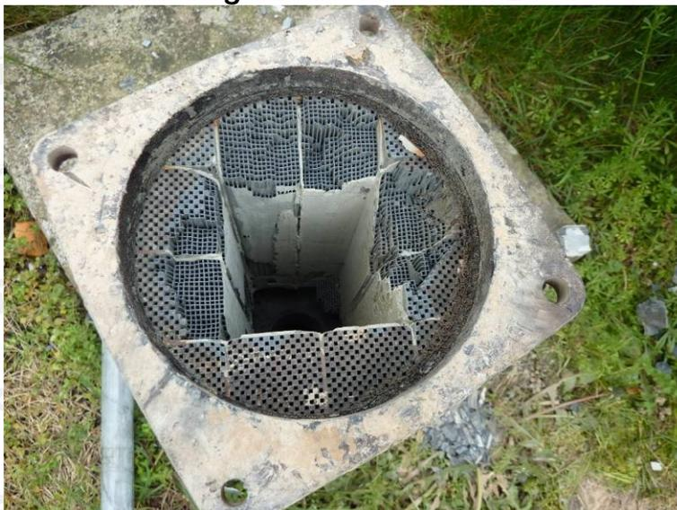
A la fin, toute la céramique (très dure et coupante) avec des bouts de grillages fins et semble t-il sur toute la paroi une couche d'amiante (si c'en est pas, elle y ressemble beaucoup).
