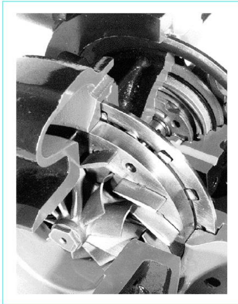
Figure 15 – Turbine à géométrie variable à ailettes pivotantes (doc. Honeywell-Garrett)
